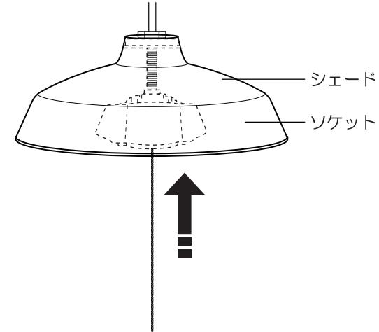
2 コード調節パートを使って、下記図のようにコードをお好みの長さに調節します。
