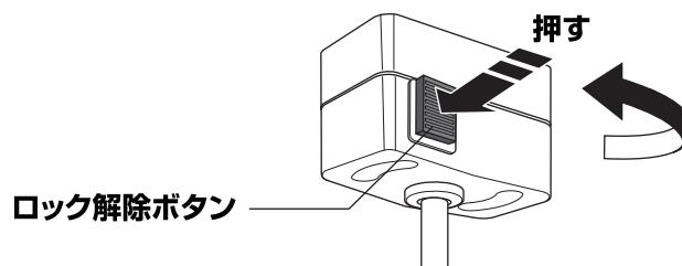
引掛けシーリングキャップを取り外す際は、引掛けシーリングキャップの根本にある『ロック解除ボタン』を押しながら左へ回します。
